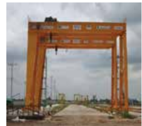
GANTRY CRANE เครนแบบมีขา 2 ข้าง
